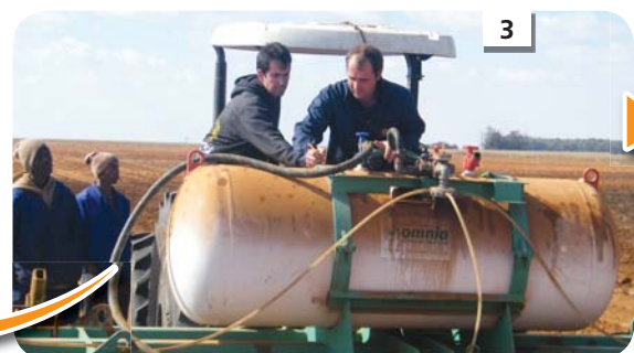
3 Op die plaas word NH 3 na nog 'n kleiner tenk (half ton), wat aan die produsent se beitelploeg gemonteer is, oorgeplaas.
