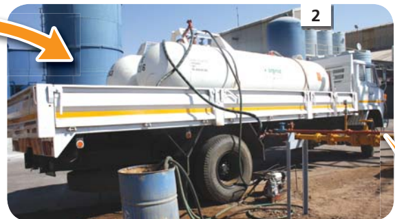
2 NH 3 word na die twee 2 ton tenks op die vragmotor oorgeplaas, wat dit na die produsent se plaas neem vir toediening.
